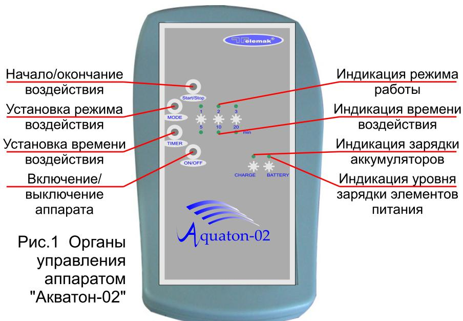
Рис.1 Органы управления аппаратом "Акватон-02"
